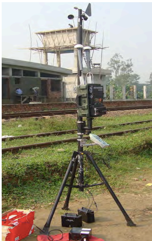
Рис. 6: EPAS: Многофункциональный сканер и комплект для сбора данных в действии в рамках долгосрочной программы АБР по мониторингу качества воздуха и уровня шума близ ж/д
