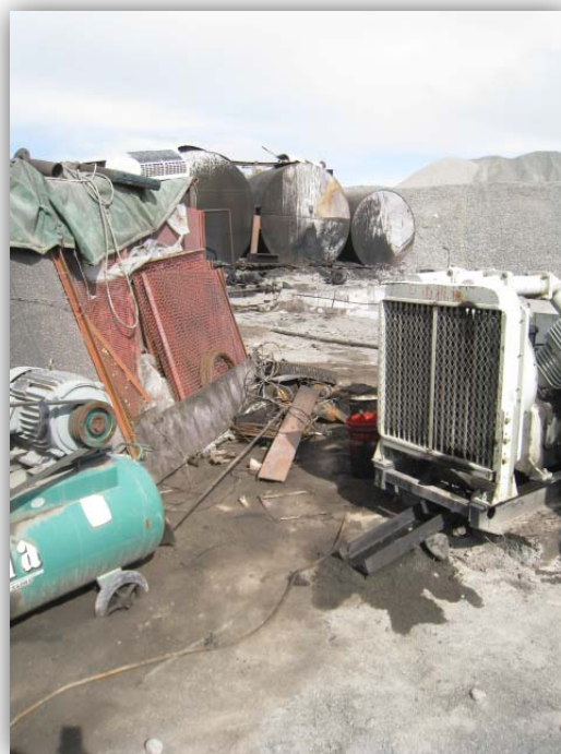
Рисунок 8. (Группа 2) Найдены многочисленные следы масла, где отсутствует защитное покрытие/цементное покрытие.
