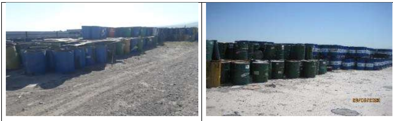
Рисунок 20 Бочки с битумом на специально подготовленной площадке
