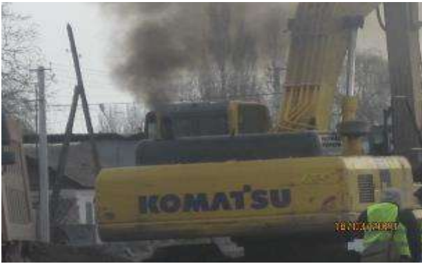
Рисунок 52 Неудовлетворительное техническое состояние экскаватора
