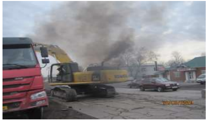
Рисунок 52 Неудовлетворительное техническое состояние экскаватора
