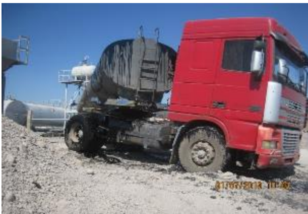
Рисунок 44 Утечки битума на территории АБЗ
