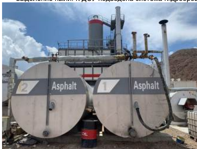
Фото 102. Маркировка емкостей на АБЗ
